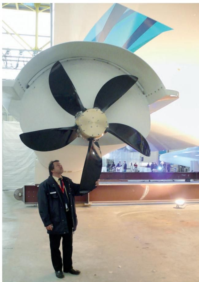
**Figure 4** Une des hélices de PlanetSolar. Ces hélices, d'un diamètre de 2 m, ont des pales orientables et leur fonctionnement semi-immersé assure un rendement très élevé, allant jusqu'à 80 % selon les conditions d'utilisation.
